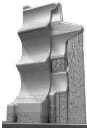
Využití technologie 3D tisku k výrobě metalurgického nářadí (K. Kubíková, 2016)
