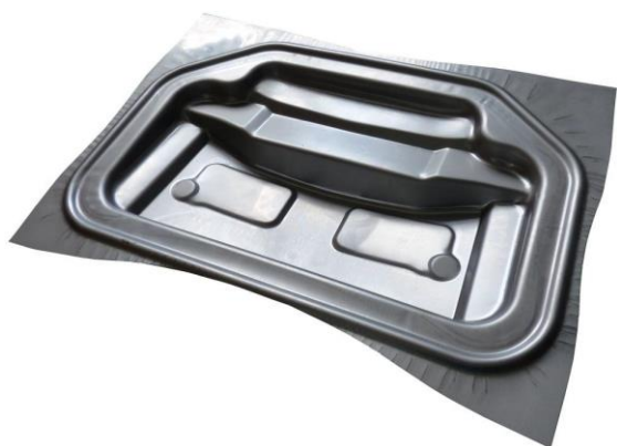
Tažení výlisku z korozivzdorného materiálu při použití nástroje s proměnnou přídržovací silou (M. Herman, 2015)
