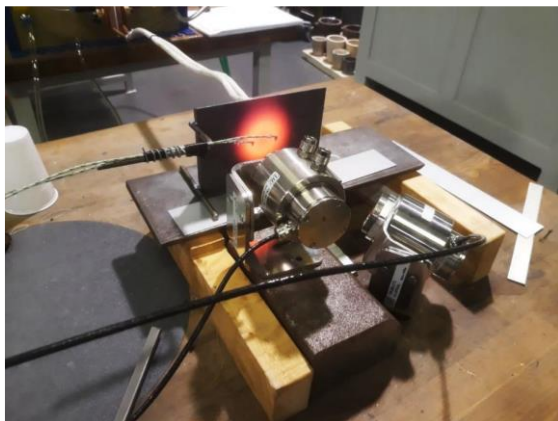
Lokální opravy smaltovaných (anorganických) povrchů pomocí indukčních ohřevů (K. Ungr, 2020)
