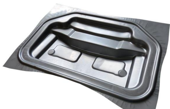
Tažení výlisku z korozi-vzdorného materiálu při použití nástroje s proměnnou přidržovací silou (M. Herman, 2015)
