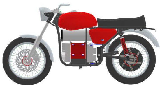
Koncept motocyklu s vodíkovým palivovým článkem (T. Němec, 2023)
