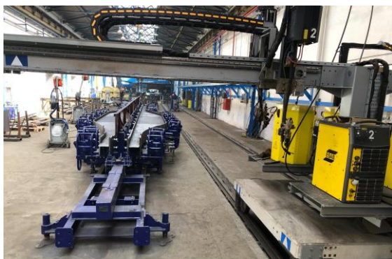
Inovace přípravku pro svařování podélníků (V. Vlček, 2023)
